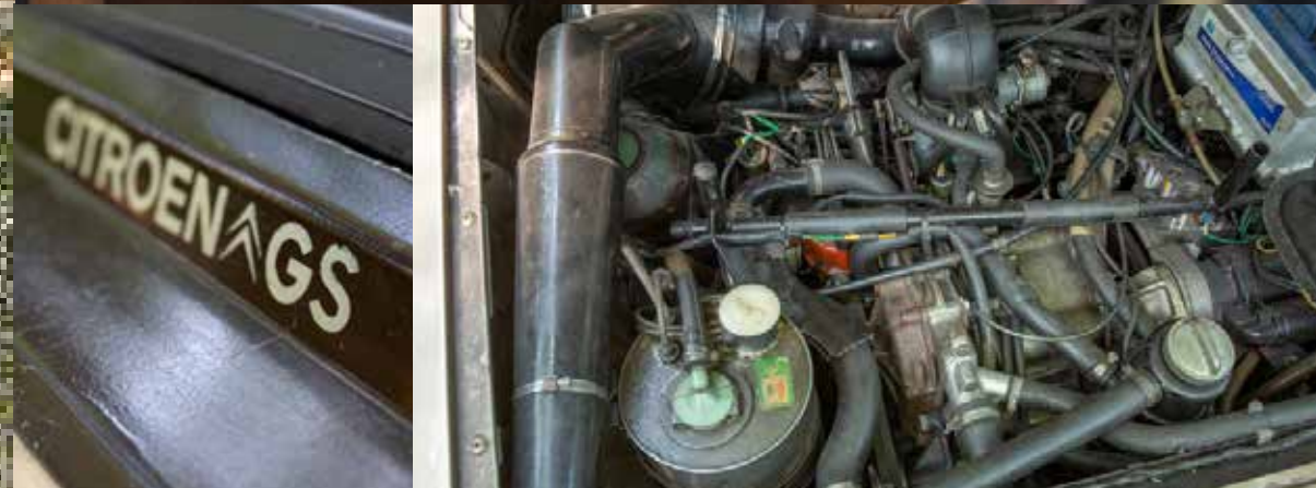
Typerend voor Citroën zijn het enkelspaaks stuurwiel en de nogal breekbaar ogende stengeltjes voor ruitenwisser en clignoteur. Rechts onder: de wankelmotor heeft relatief weinig bewegende delen.
